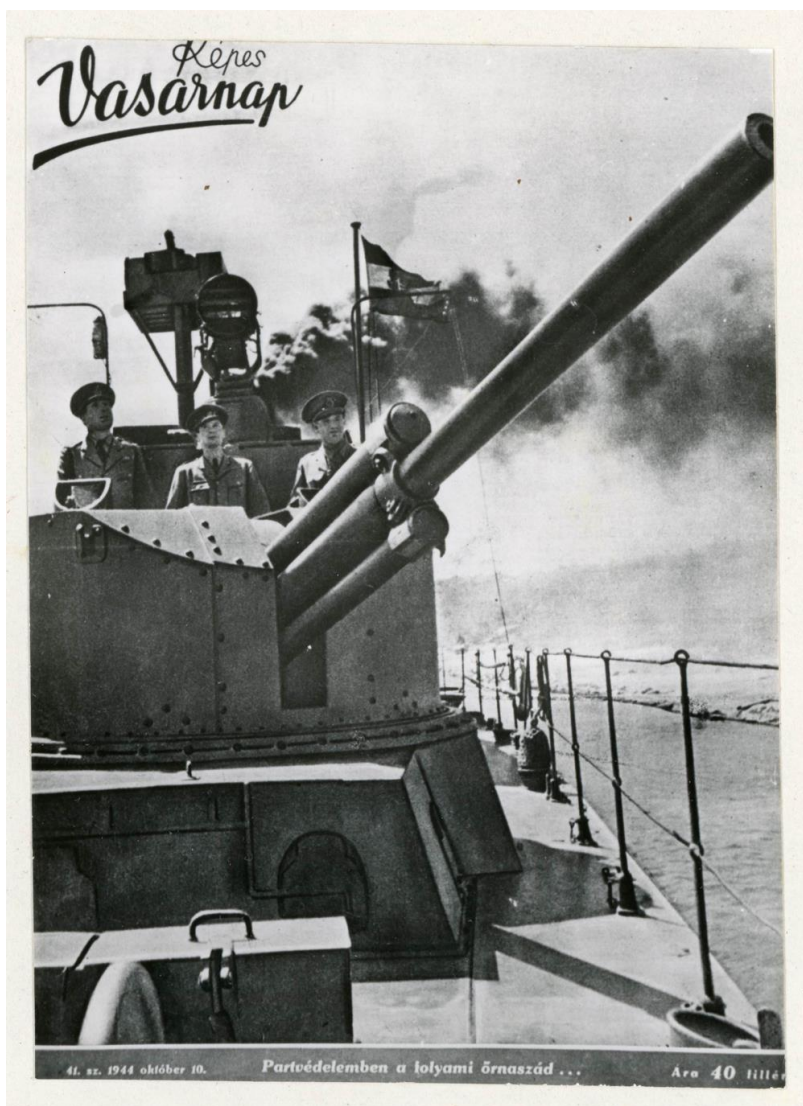
/HTM 30454 A Győr (ex Compó) őrszázad felszerelve Bofors 29 M 8 cm-es légvédelmi ágyúval. Az úszóegységek egy részére 1941 tavaszán árbockosárra hasonló géppuskaállást szereltek fel, mert a Száva magas partjai között a fedélzeti fegyverekből nem tudták elérni a parti célokat/
